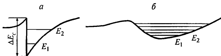
Рис. 2.1. Потенциальный профиль края зоны проводимости для резкого (а) и плавного (б) гетеропереходов.
